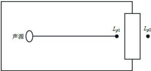
图 7 室内声源等效为室外声源图例
