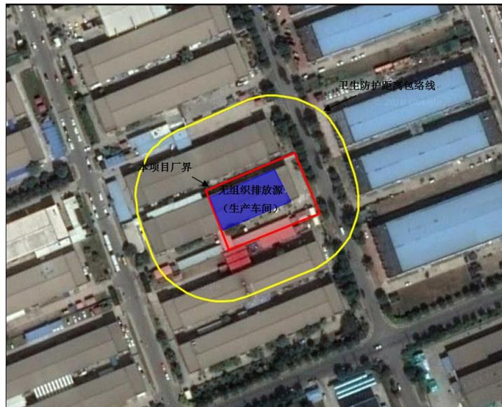
图 8 卫生防护距离包络线图
